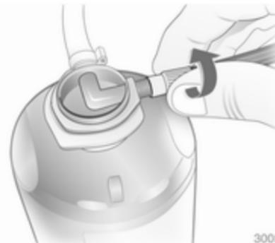
2. Staccare il tubo dell'aria dalla staffa e avvitarlo al raccordo della bombola.
