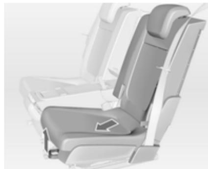
Tirare la maniglia e far scivolare il sedile in senso trasversale in avanti fino alla posizione 2. Il sedile viene guidato automaticamente all'esterno. Rilasciare la maniglia e consentire al sedile di tornare in posizione.
