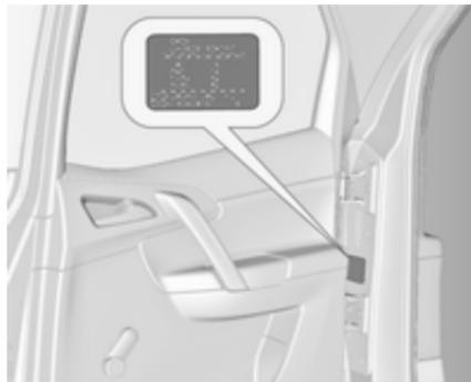
La targhetta di identificazione si trova sul telaio della portiera posteriore destra.
