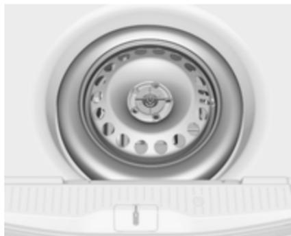
La ruota di scorta è situata nel vano di carico sotto la copertura del pianale. È fissata con un dado ad alette. L'alloggiamento della ruota di scorta non è progettato per contenere pneumatici di tutte le dimensioni consentite. Se una ruota più grande della ruota di scorta deve essere riposta nel vano di carico, deve essere assicurata con una fascetta oppure, a seconda della versione, con una barra di prolunga.
