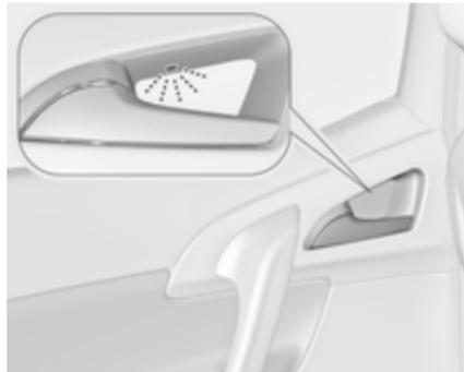
I LED verdi indicano che è possibile aprire le portiere dall'interno: Afferrare la maniglia interna della portiera posteriore per attivare il sensore di prossimità e tirare la maniglia.
