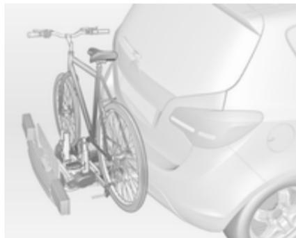
Le biciclette possono essere trasportate su un portabiciclette estraibile integrato nel pavimento della vettura (sistema Flex-Fix). Non è permesso trasportare altri oggetti.
