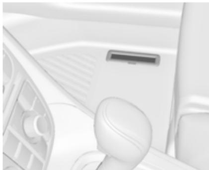
Il numero di telaio è stampigliato sulla targhetta di identificazione e sul pannello del pavimento, sotto al rivestimento, visibile sotto a una copertura.
