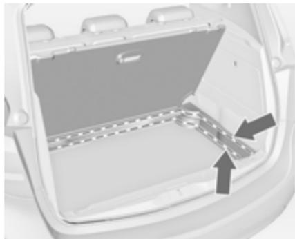
Se montato nella posizione superiore, lo spazio tra il doppio fondo e la copertura del vano per la ruota di scorta può essere utilizzata come vano di stivaggio.
