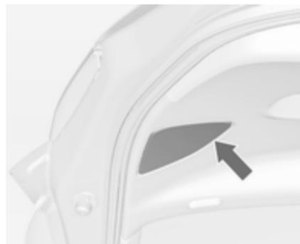
1. Aprire il portellone posteriore e rimuovere la copertura con un cacciavite.
