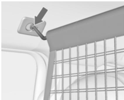
Il telaio del tetto ospita due aperture per il montaggio. Appendere l'asta della rete su un lato, premere sulla parte anteriore e fare scattare in posizione. Allungare l'asta, appenderla sull'altro lato, premere sulla parte anteriore e fare scattare in posizione.
