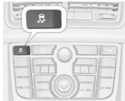
Il sistema di controllo della trazione può essere disattivato quando è richiesto lo slittamento delle ruote motrici: premere brevemente il pulsante
