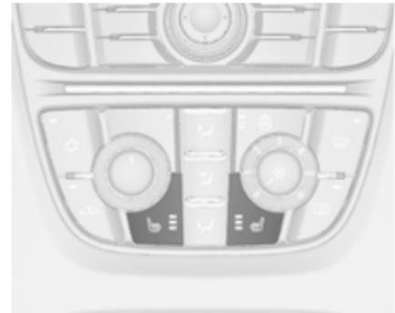
Regolare il riscaldamento sul livello desiderato premendo il pulsante
