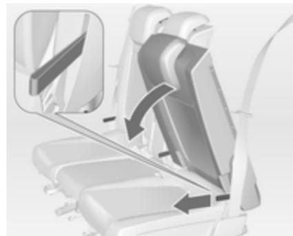
Tirare la maniglia sul lato anteriore dello schienale e reclinare lo schienale sulla seduta. Il sedile si abbassa automaticamente.
