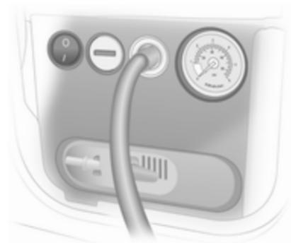
8. Premere l'interruttore di accensione/spengimento sul compressore. Il pneumatico viene riempito di sigillante.
