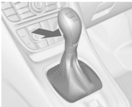
Per innestare la retromarcia con il veicolo fermo, attendere 3 secondi dopo aver premuto il pedale della frizione, quindi premere il pulsante di sblocco sulla leva del cambio e inserire la marcia.
