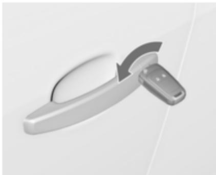
Sbloccare manualmente la portiera del conducente girando la chiave nella serratura. Inserire l'accensione e premere il pulsante di chiusura centralizzata per sbloccare tutte le portiere, il vano di carico e lo sportellino del carburante.
