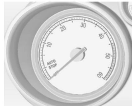
Indica la velocità di rotazione del motore.
