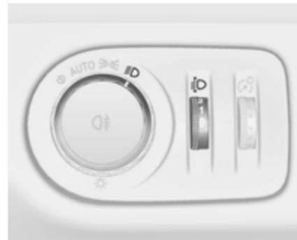
Per regolare la profondità delle luci in base al carico del veicolo e non abbagliare i conducenti dei veicoli in avvicinamento: ruotare l'interruttore rotante
