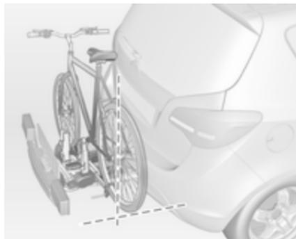
Allineare la bicicletta nella direzione longitudinale del veicolo. Allentare leggermente il fissaggio del pedale.
