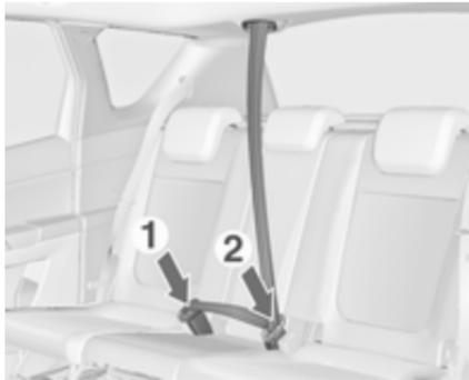
Inserire a pressione la piastra di chiusura inferiore nella fibbia destra (1) del sedile centrale. Rimuovere la piastra di chiusura superiore dal fermo, portare la cintura sulla spalla e sull'addome (senza torcerla) e inserirla nella fibbia sinistra (2) del sedile centrale.
