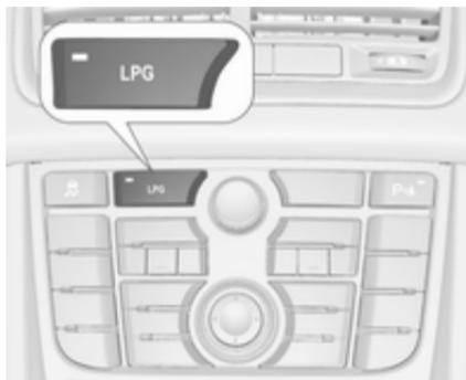
Premendo il pulsante **LPG** si passa tra il funzionamento a benzina e quello a gas liquido. Lo stato del LED mostra l'attuale modalità di funzionamento.
