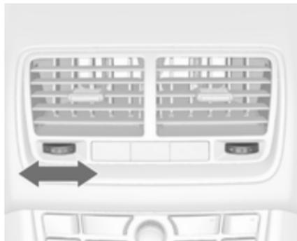
Per aprire la bocchetta, ruotare la manopola di regolazione verso destra. Regolare la quantità di aria all'uscita della bocchetta ruotando la manopola di regolazione.
