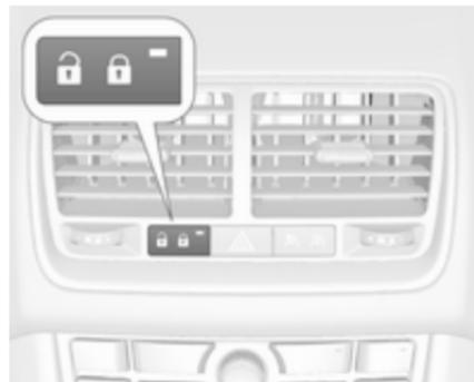
Premere il pulsante della chiusura centralizzata: le portiere vengono bloccate o sbloccate. Se le portiere vengono bloccate, il LED del pulsante si accende.
