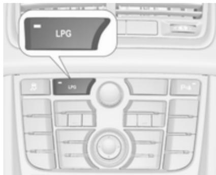
Premendo il pulsante **LPG** si passa dal funzionamento a benzina e gas liquido e viceversa non appena i parametri necessari (temperatura di raf-
