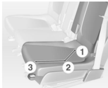
È possibile configurare la fila posteriore di sedili in modo che comprenda due sedili e il massimo spazio di seduta nella posizione 1, oppure con tre sedili nella posizione 2. Nella posizione 1, il sedile centrale viene abbassato.
