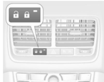
Il LED di stato è integrato nel pulsante di bloccaggio centrale.
