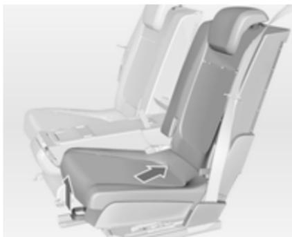
Tirare la maniglia e far scivolare il sedile in senso trasversale all'indietro fino alla posizione 1. Il sedile viene guidato automaticamente all'interno. Rilasciare la maniglia e consentire al sedile di tornare in posizione.
