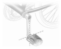
Ruotare il pedale sinistro (senza ingranaggio della catena) verticalmente verso il basso. Il pedale della pedivella sinistra deve essere orizzontale.
