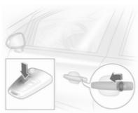
Girare la chiave nella serratura della portiera lato guida verso la parte anteriore oppure premere il pulsante per sbloccare le portiere e il vano di carico. Aprire le portiere tirando le maniglie. Per aprire il portellone posteriore, tirare il pulsante sotto la modanatura del portellone posteriore.
