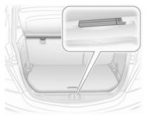
Riporre il triangolo di segnalazione nella parete del vano di carico posteriore: prima posizionare il triangolo di segnalazione nella sagomatura a sinistra e poi inserirlo nella guida a destra.
