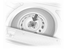
La ruota di scorta è situata nel vano di carico sotto la copertura del pianale. È fissata mediante un dado ad alette.
