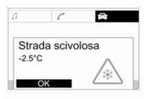
Nei veicoli con Graphic-Info-Display o Color-Info-Display, nel display appare anche un messaggio di avvertimento sulla possibile presenza di strade ghiacciate. Al di sotto di -5 °C non viene visualizzato alcun messaggio.
