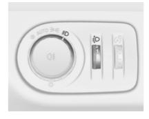
Per adattare la profondità delle luci al carico del veicolo ed evitare l'abbagliamento: ruotare la rotella o fino a visualizzare l'impostazione richiesta sul display dei chilometri. La visualizzazione rimane per 4 secondi, quando gli anabbaglianti sono accesi oppure ogni volta che si cambia profondità di illuminazione, assieme al simbolo o.
