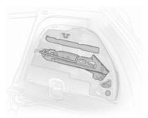
Il martinetto e gli attrezzi della vettura si trovano nel vano a destra del vano bagagli.
