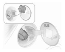
Sbloccare il tappo del serbatoio del carburante con la chiave di accensione, svitarlo e rimuoverlo. Il tappo del serbatoio del carburante può essere posato sull'apposita staffa presente sullo sportellino del carburante.
