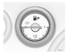
Visualizza il livello del carburante nel serbatoio.
