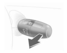
Tirare la leva. Il liquido di lavaggio viene spruzzato sul parabrezza e il tergicristalli effettua alcuni passaggi.
