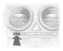
Attivare il riscaldamento in combinazione con il riscaldamento del sedile premendo il pulsante ## suna o più volte con l'accensione inserita.
