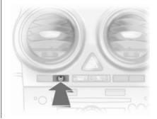
Dopo aver regolato la pressione dei pneumatici o cambiato una ruota, è necessario inizializzare il sistema: inserire l'accensione, tenere premuto il pulsante **DDS** per circa 4 secondi. La spia ① lampeggia tre volte.
