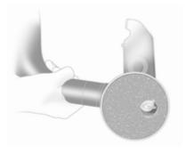
Quando si inserisce, montare il cappuccio protettivo sulla manopola girevole con la chiave.
