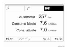
L'autonomia viene calcolata in base al livello corrente di carburante nel serbatoio e al consumo corrente. Il display visualizza valori medi.
