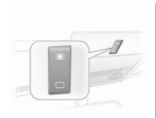
Funzionamento mediante interruttore a bilanciere nella consolle del tetto.
