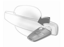
Ruotare del tutto la chiave nella serratura della portiera del conducente. All'apertura della portiera del conducente viene sbloccato l'intero veicolo. Per sbloccare le altre portiere, inserire l'accensione e premere il pulsante della chiusura centralizzata.
