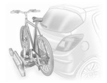
Il sistema di trasporto posteriore (sistema Flex Fix) consente di montare le biciclette su un sistema a estrazione integrato nel pianale del veicolo.
