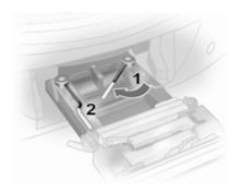
Ruotare in avanti prima la leva di fissaggio destra (1), poi la leva di fissaggio sinistra (2), fino a quando non si innestano nei rispettivi alloggiamenti.
