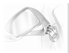
Corsa OPC: per la sicurezza dei pedoni, gli specchietti esterni di Corsa OPC si staccano dal supporto in caso di urti. Montare il corpo dello specchietto sul supporto con le apposite alette e bloccarlo colpendolo leggermente.
