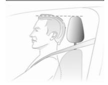
Il bordo superiore del poggiatesta dovrebbe trovarsi all'altezza della parte superiore della testa. Se questo non è possibile, nel caso di persone molto alte, regolare il poggiatesta alla posizione più alta e per persone di bassa statura utilizzare la posizione più bassa possibile.
