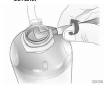
Staccare il tubo dell'aria dalla staffa e avvitarlo al raccordo della bombola.
