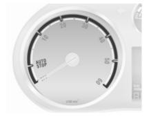
Indica la velocità di rotazione del motore.
