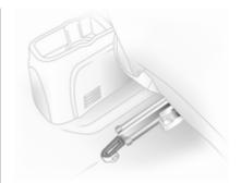
Sul rivestimento del montante del tetto posteriore e sui punti di fissaggio sono presenti appositi simboli che indicano gli occhielli di fissaggio sui quali va montato il sistema di sicurezza per bambini.
