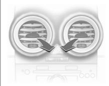
Regolare la direzione del flusso dell'aria ruotando la rotella di regolazione da destra a sinistra e sollevare oppure abbassare le alette orizzontali.
