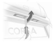
Inserire un cacciavite nell'alloggiamento della lampadina, premere verso il lato e rilasciare la molla.
