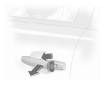
Girare la chiave nella serratura della portiera del conducente verso la parte anteriore.
