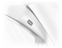
Il sistema airbag a tendina è composto da due airbag incorporati nel telaio del tetto, uno per lato. La loro presenza viene segnalata dalla scritta AIRBAG sui montanti del tetto.
