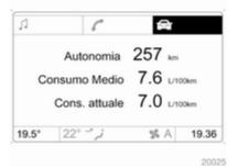
Visualizza l'ora, la temperatura esterna e la data oppure informazioni relative al sistema Infotainment (quando è acceso) e al sistema di climatizzazione elettronico.
