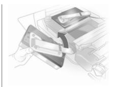
Aprire il supporto della lampada sulla parte posteriore delle luci posteriori fino a quando si blocca in posizione.
