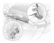
Per sostituire le lampadine sul lato destro del vano motore, staccare il tubo flessibile dell'aria dal filtro dell'aria.
