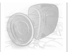
Il movimento inerziale in avanti di chi occupa i sedili anteriori viene rallentato, riducendo notevolmente il rischio di lesioni alla parte superiore del corpo e alla testa.
