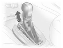
Staccare la parte anteriore del rivestimento della leva selettrice dalla consolle centrale, sollevarlo e ruotarlo verso sinistra
