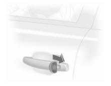
Girare la chiave nella serratura della portiera del conducente verso la parte posteriore.
