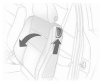
Sollevare la leva di sblocco e piegare lo schienale in avanti. Abbassare la leva di sblocco: lo schienale si blocca nella posizione abbassata. Far scorrere il sedile in avanti.
