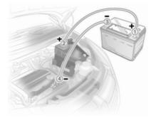
Disporre i cavi in modo che non si impiglino nelle parti in movimento all'interno del vano motore.
