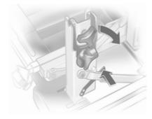
Sbloccare la leva di blocco sul supporto diagonale e piegare verso il basso le cavità della pedivella.
