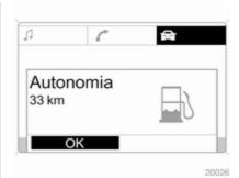
Quando il livello di carburante nel serbatoio è basso, il display visualizza il messaggio **Autonomia**.
