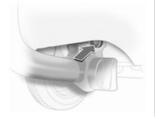
Occhiello per il cavo di sicurezza Fissare il cavo di sicurezza all'occhiello
