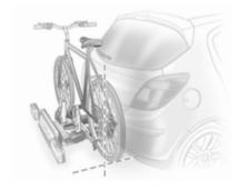
Allineare la bicicletta nella direzione longitudinale del veicolo. Allentare leggermente il fissaggio del pedale.
