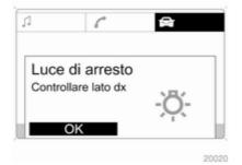
Il guasto delle luci viene indicato nel display informativo oppure nel display del quadro strumenti viene visualizzato il messaggio **InSP2**.
