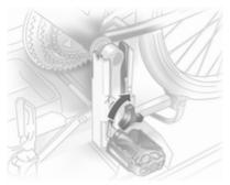
Fissare la pedivella ruotando l'apposita vite al fissaggio della pedivella.
