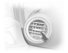
Per chiudere la bocchetta, ruotare la rotella di regolazione verso sinistra o verso destra fino a fine corsa.
