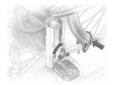
Serrare manualmente la vite del supporto del cuscinetto del pedale.
