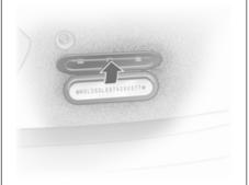
Il numero di telaio (VIN) si trova sulla targhetta di identificazione della vettura e sul sottoscocca, sotto la copertura del pianale, ed è visibile attraverso una protezione.
