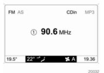
I dati sono visualizzati sull'Info-Display. Le modifiche delle ipostazioni vengono visualizzate brevemente nell'Info-Display, sovrapponendosi al menu correntemente visualizzato. Il sistema di climatizzazione elettronico è pienamente operativo solo quando il motore è in funzione.
