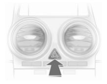
Inserimento con il pulsante <u>A</u>. I segnalatori di emergenza si inseriscono automaticamente in caso di attivazione degli airbag.
