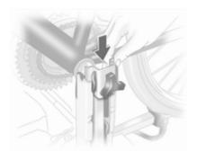
Inserire dall'alto il fissaggio della pedivella nella guida esterna di ogni alloggiamento e farlo scivolare verso il basso il più possibile.
