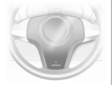
Il sistema airbag anteriore è composto da un airbag nel volante e un airbag nel quadro strumenti sul lato passeggero anteriore. La loro presenza viene segnalata dalla scritta AIRBAG.
