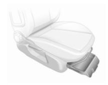
Sollevare in corrispondenza del bordo rientrante ed estrarre. Carico massimo: 1,5 kg. Per chiudere il vano, spingerlo indietro e bloccarlo in posizione
